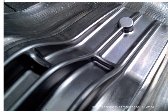
Geschmiedetes Mg-Strukturbauteil unmittelbar nach der Umformung
